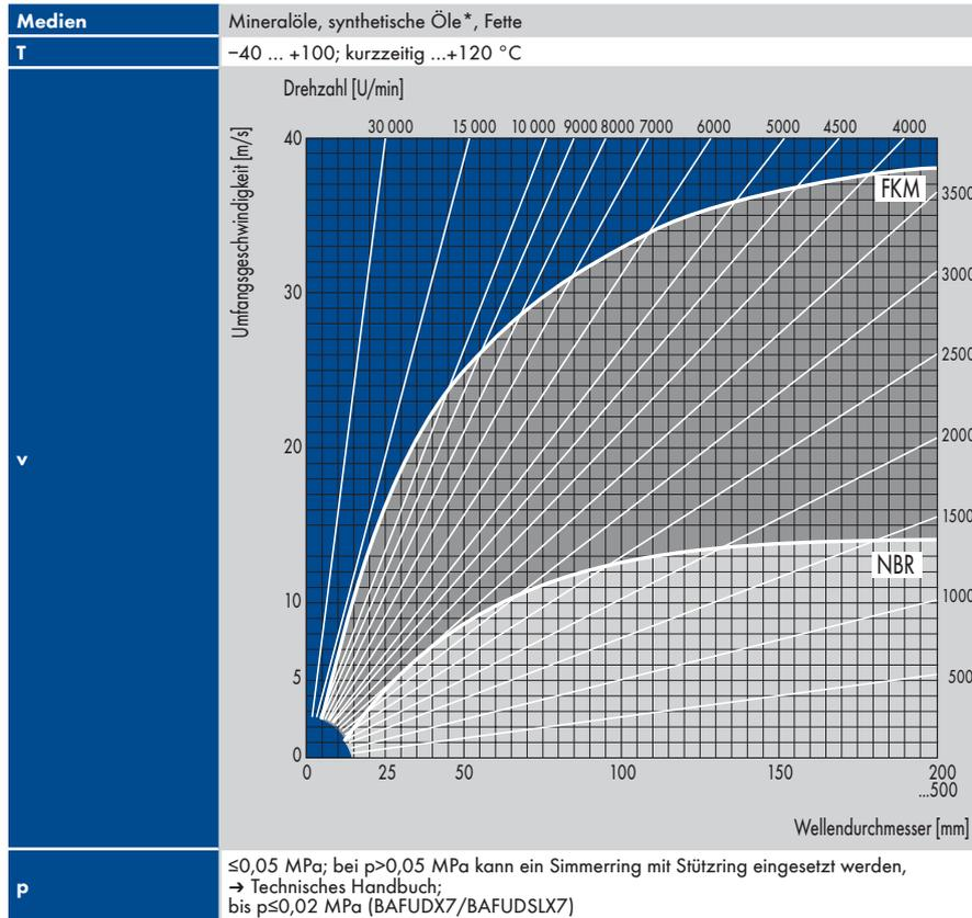
Zulässige Umfangsgeschwindigkeit für Simmerringe aus den Werkstoffen NBR (72 NBR 902) und FKM (75 FKM 585) bei der Abdichtung von Motorenöl SAE 20. Einsatz Simmerring mit SL (Schutzlippe):  $v = \max. 8$  m/s
