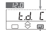
Temps dérivée froid Peut être exclu (seulement pour conf. Chaud/Froid) OFF / 0.1...999.9 secondes
