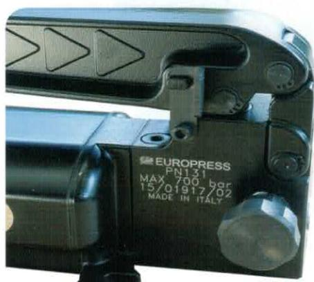
Der Pumpenkopf ist so geformt, dass er den Boden berührt. Auf diese Weise kann hervorragendes Zubehör montiert werden, ohne dass der vordere Fuß zu stark schwankt. Außerdem kann die Pumpe über die Bohrungen oder die Befestigungsgabeln an den Standfüßen an Halterungen befestigt werden.
